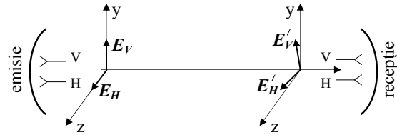
Fig. 6.40. Transmisie cu unde polarizate ortogonale. Depolarizarea undelor la receptor
